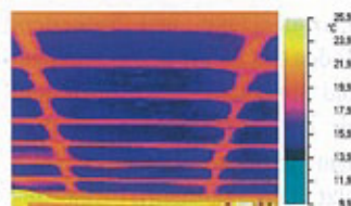
Die Wärmebildaufnahme zeigt die homogene Temperaturverteilung der Kühldecke.
